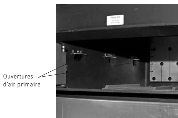
Fig. 37 Décrocher les tôles suspendues ; contrôler les ouvertures d'air primaire.
