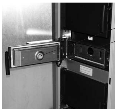
Fig. 26 Contrôler les ouvertures d'allumage
