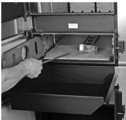
Fig. 6 Accrocher le tiroir à cendres, vider les cendres
