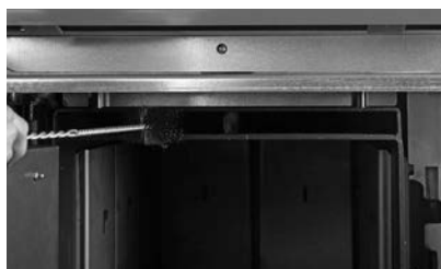
Fig. 29 Nettoyer le système d'aspiration des gaz
