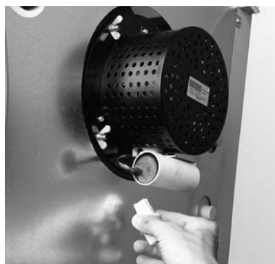
Fig. 31 Débrancher le connecteur du ventilateur et retirer les écrous à oreilles
