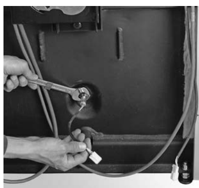
Fig. 40 Débrancher et dévisser la sonde lambda
