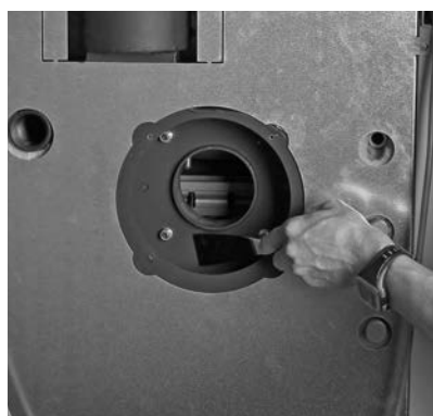
Fig. 33 Nettoyer l'intérieur du caisson de ventilateur
