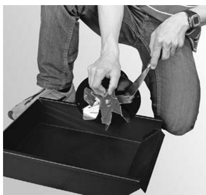
Fig. 32 Nettoyer la roue du ventilateur
